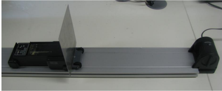
איור 6: המערכת הניסיונית למדידת מהירויות העגלה בעזרת חיישן התנועה של פסקו.
